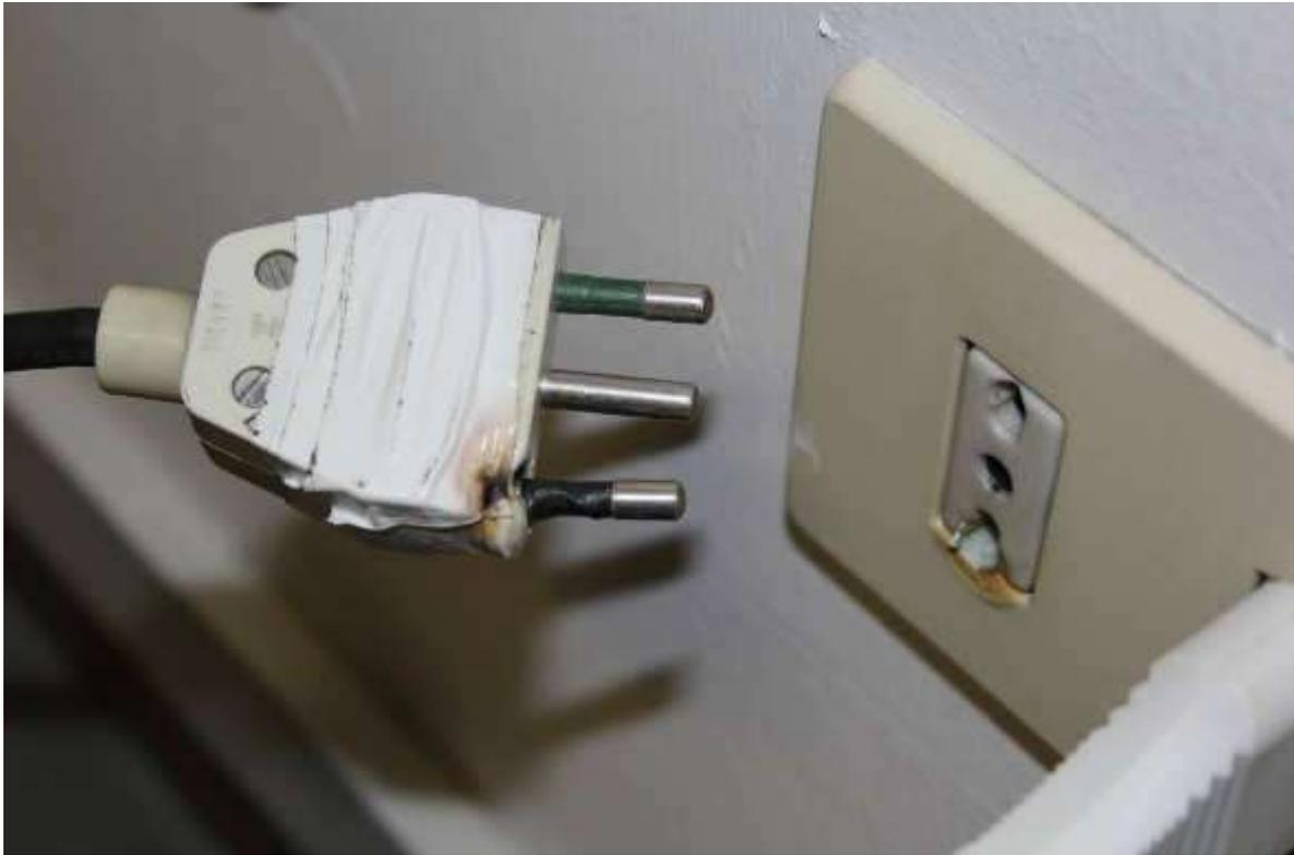
Di seguito il particolare sul puntale e l'involucro di plastica della spina con i segni del principio di incendio:
