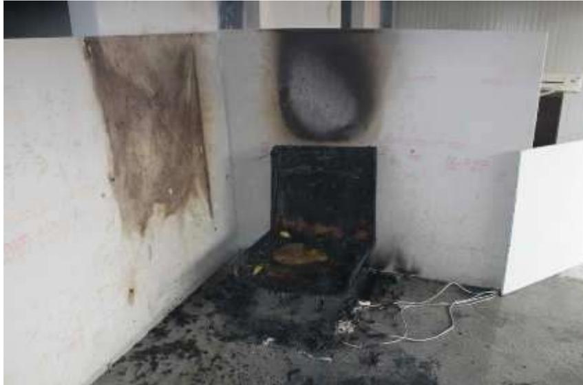
Scopo della prova era quello di evidenziare i rischi riconducibili ad un uso scorretto di una multipresa e la facilità con la quale, da un surriscaldamento della stessa, possa scaturire un incendio che poi rapidamente si propaga sui materiali combustibili più comuni (un tappeto, una moquette, una sedia o la poltrona di un ufficio).
