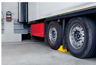
1 Veicolo stazionato nel punto di carico e messo in sicurezza con gli appositi cunei bloccaruote
