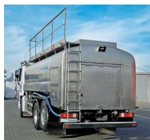
3 Scaletta fissa con parapetto ribaltabile su un autocarro
