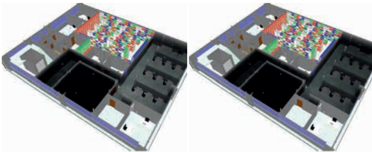
FDS output: simulazione scenario 2 - propagazione del fumo a 360 s e a 420 s
