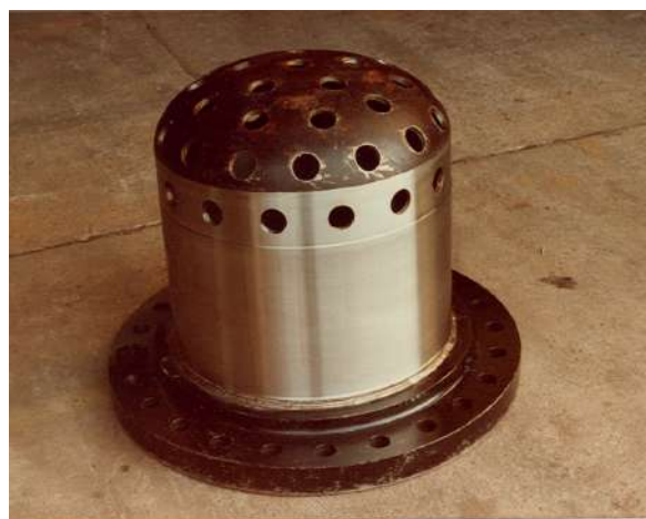
Figura 23.4 - Particolare di un espansore per scarico vapore.
