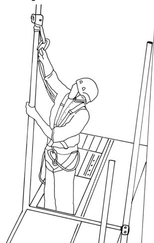
Accesso al primo impalcato
