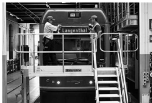
Foto 9: eseguire i lavori di manutenzione da una pedana sicura.
