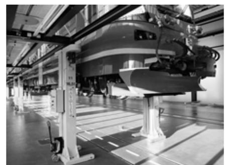
Foto 12: martinetti idraulici con indicazione della portata
