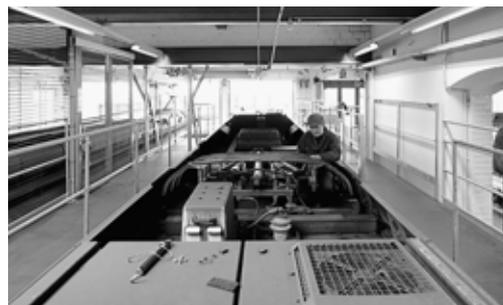
Foto 8: lavorare ai pantografi sul veicolo. La passerella è munita di parapetti estraibili.
