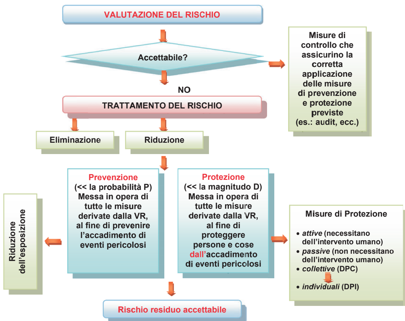
SCHEMA D'AZIONE PER LA GESTIONE DEL RISCHIO
