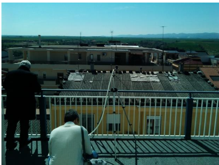
Figura 5 – Campionamento esterno di fibre aerdisperse
