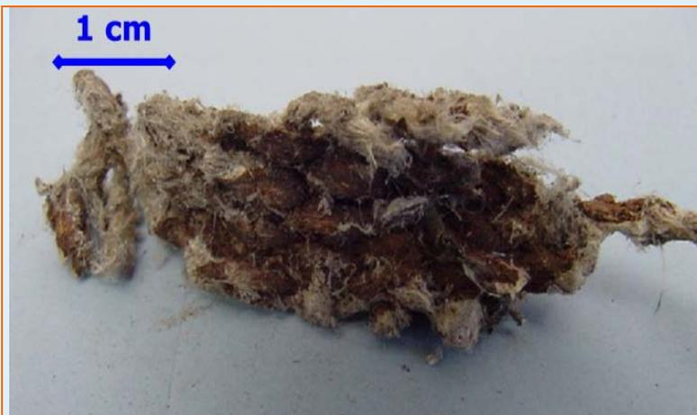
Corda in amianto crisotilo a suo tempo utilizzata come termoisolante negli sportelli di ispezione di un forno industriale.
