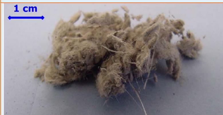
Lana di vetro applicata a spruzzo su strutture metalliche. Si tratta di un materiale difficile da discriminare rispetto all'amianto (le fibre sono molto sottili). La consistenza è leggermente più granulare, il colore analogo.
