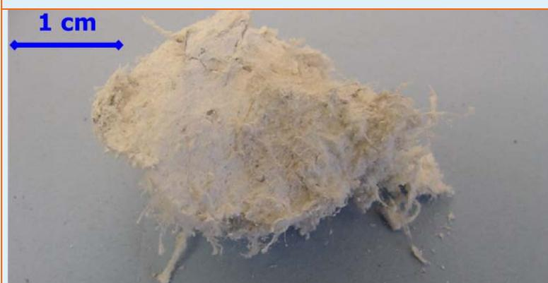
Coibentazione contenente amianto amosite a suo tempo utilizzata come protezione di tubazioni di vapore.
