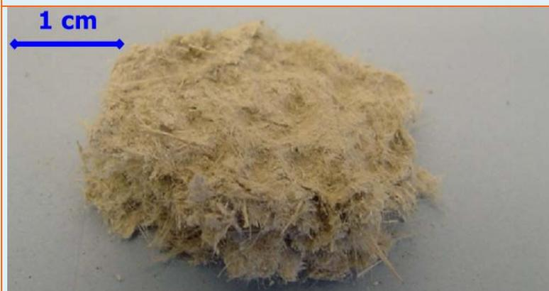
Coibentazione in amianto amosite a suo tempo utilizzata come ignifugo applicato a spruzzo in elementi metallici di una struttura edilizia.
