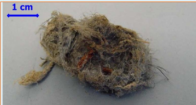
Coibentazione in amianto crocidolite a suo tempo utilizzata a protezione di una tubazione di aria compressa.
