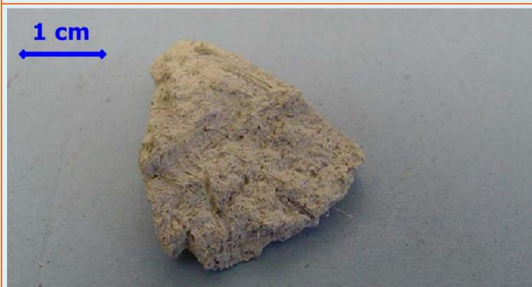
Coibentazione isolante da una vasca di decappaggio di un'industria chimica.
