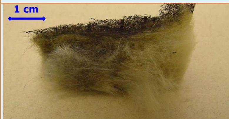
Isolante in lana di roccia utilizzato all'interno di tubazioni di areazione di un edificio civile. Materiali perfettamente identici sono utilizzati, oltre che come isolanti, in edilizia nella realizzazione di pannelli e controsoffitti. Si nota la differenza di colore rispetto ai materiali contenenti amianto.
