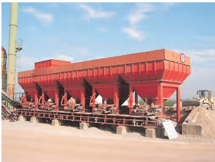
Figura 17 - Tramogge di predosatura ponderale
